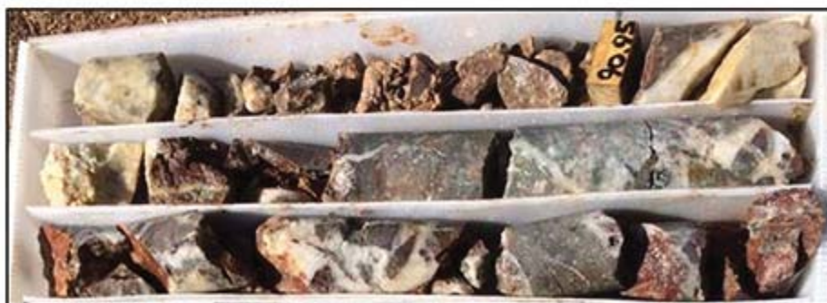
UB17-011; 3.7m grading 2.58 gpt Au, 332.6 gpt Ag, 526 gpt AgEq*
